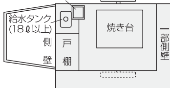
洗浄設備・手洗い・消毒設備を備える
