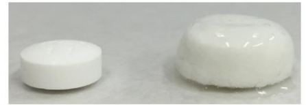
写真 とろみ剤に30分間浸漬させた酸化マグネシウム錠の比較 非浸漬錠(左)の水中崩壊時間は7秒程度。一方、とろみ剤に30分間浸漬させた浸漬錠は、膨潤するが崩壊しない(右)。
